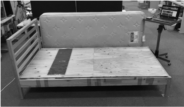
図5 圧力センサの設置状況
