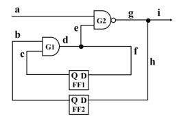
図3. スキャン設計済み順序回路
