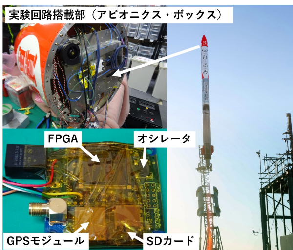
図 1 MOMO3 号機に搭載した実験用回路とその打ち上げ
