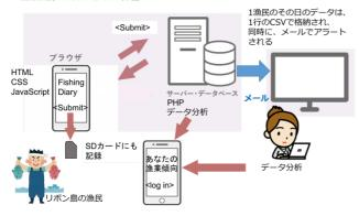
図 1 Web 操業日誌システムの概念図
