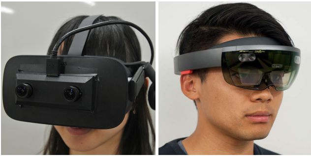
図 1 ビデオ透過型 HMD(左図) と光学透過型 HMD(右図). (文献 [4] より引用)
