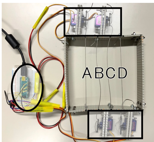
図 3 足場形状再現装置の試作
