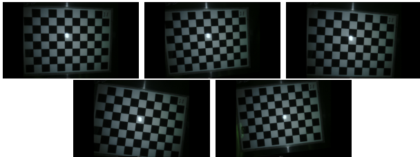
図 3: カメラキャリブレーションのために撮影したチェックパターン画像群
