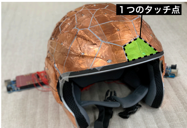
図 2.ヘルメット型タッチインタフェースのプロトタイプ
