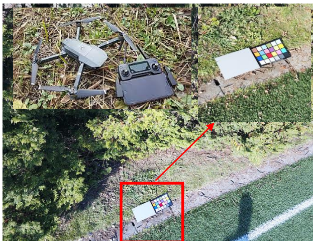
図1 空撮に使用したドローン(DJI Mavic Pro), Macbeth 標準24色票とグレーカード
