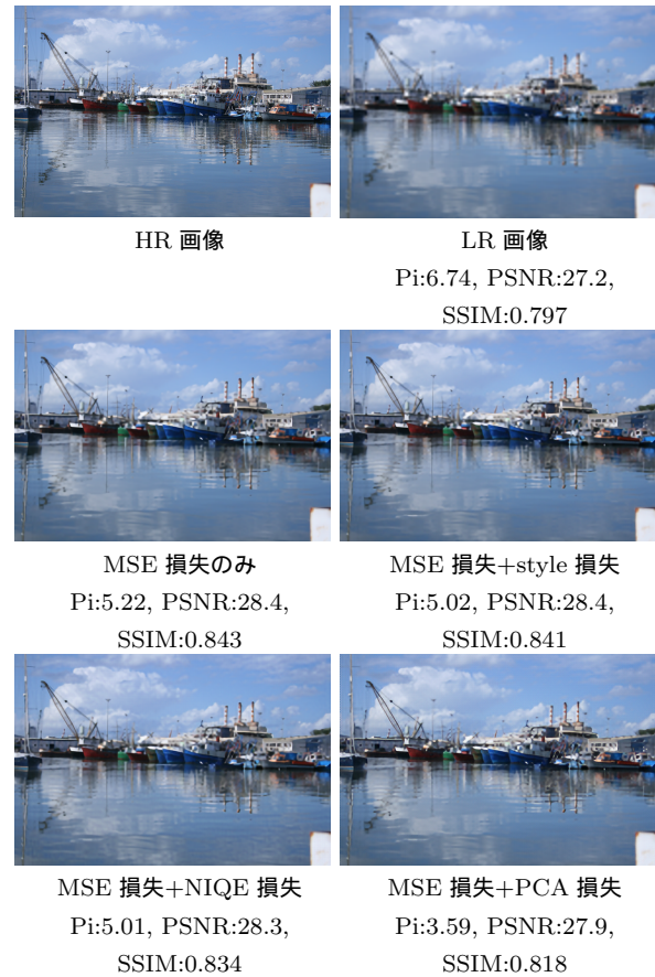
図 7 図 6 と同様にして生成された SR 画像と HR 画像, LR 画像. MSE 損失に NIQE 損失を加えて学習し, 生成された SR 画像と各 SR 画像の Pi, PSNR, SSIM の値である. MSE 損失に NIQE 損失を加えた SR 画像は, 画像右下の海の波紋が強調されるような画像となっている.
