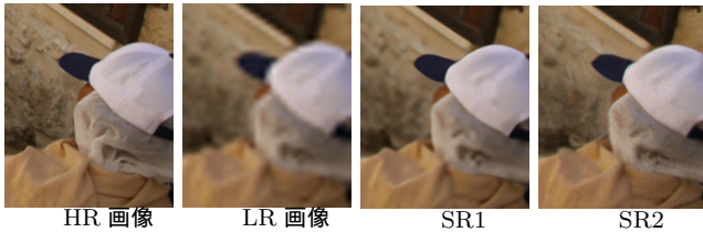
図 1 HR 画像, LR 画像 (バイキュービック補間), 復元誤差 MSE 損失のみで生成された SR 画像 SR1 と知覚評価を考慮した損失関数を用いて生成された SR 画像 SR2 の比較. SR1 の輪郭は不鮮明であるが, SR2 の人物の輪郭は先鋭的ではっきりしている.
