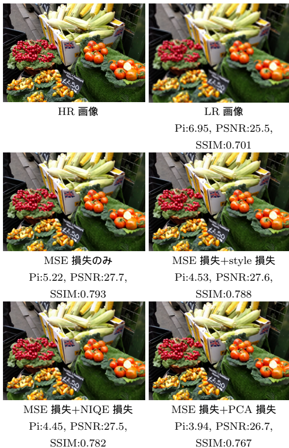
図 6 MSE 損失, MSE 損失に style 損失, NIQE 損失, PCA 損失のいずれか 1 つを加えて学習して生成した 4 つの SR 画像と HR 画像, LR 画像 (バイキュービック補間により生成) と各 SR 画像の Pi, PSNR, SSIM の値である. MSE 損失のみの学習と比較し, MSE 損失に PCA 損失を加えたものは画層中央下部の文字プレート内の文字の輪郭が先鋭化されている.
