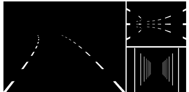
図 4 現在の速度と操舵角から推測された進行方向を描画するバーチャルパターンの例
