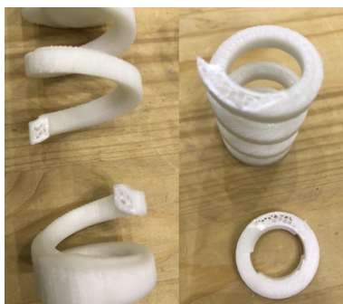
図 23 破断したコイルスプリング。左から、水平方向，垂直方向
