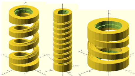
図 4 (1) コイルの外径, (2) ネジ溝径, (3) コイル線径, (4) ピッチ, (5) ネジ溝長さ, (6) 全長を調整して作成した 3 D モデルの例。左 : (1)15, (2)10, (3)5, (4)6, (5)10, (6)60, 正巻, 中央 : (1)7.5, (2)5, (3)2.5, (4)4, (5)2, (6)50, 正巻, 右 : (1)15, (2)10, (3)5, (4)6, (5)10, (6)30, 逆巻。
