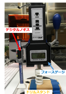
図 13 調査に用いた自作治具. フォースゲージとデジタルノギスが連動し、押下時の反発力とその時の押下量を計測
