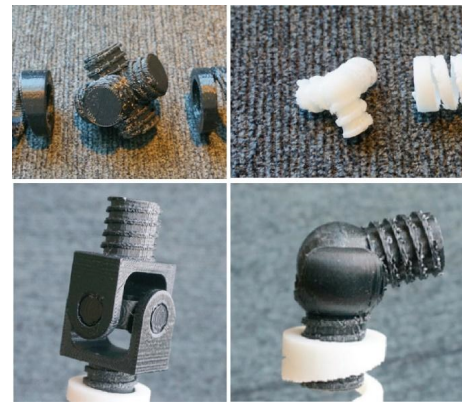
図 6 左上: 6 方向ジョイント, 右上: 三つ又ジョイント, 左下: ユニバーサルジョイント, 右下: ボールジョイント
