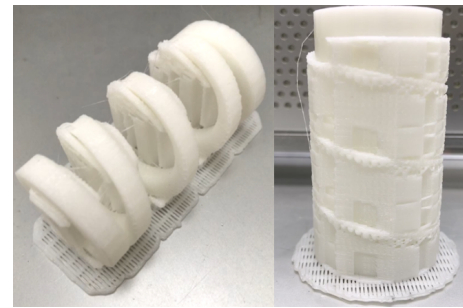
図 19 コイルスプリング出力方向. 左から, 水平出力, 垂直出力
