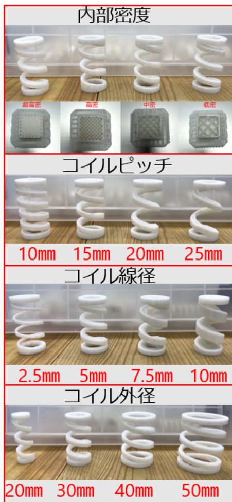
図 14 実験で使用するコイルスプリングの調整項目とパラメータ
