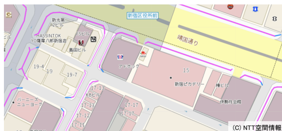
図 9 地図に重畳した、不要セグメント除去及び反り修正なしの歩道中心線 (青は幅員 1m 未満、ピンクは 1m 以上で濃いほど広い)
