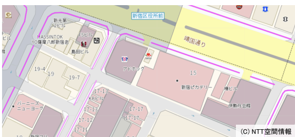
図 10 不要セグメント除去及び反り修正した歩道中心線
