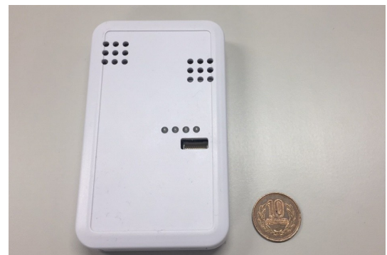
図 3 日本 GIT 社の IR-UWB タグ
