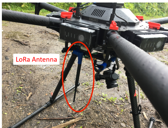
図 7 ドローンに搭載した LoRa モジュール
