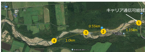
図 10 忠類川を対象とした置局設計の結果
