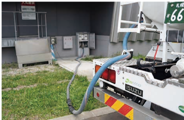
図-2 タンクローリーによる給油
