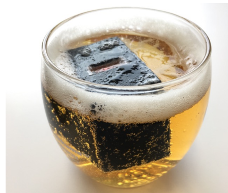
図 1: 本研究で作成したスマートアイスキューブでビールのアルコール濃度を計測している様子。
