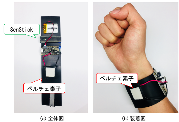
図 12 ペルチェ素子の特性調査用計測装置
