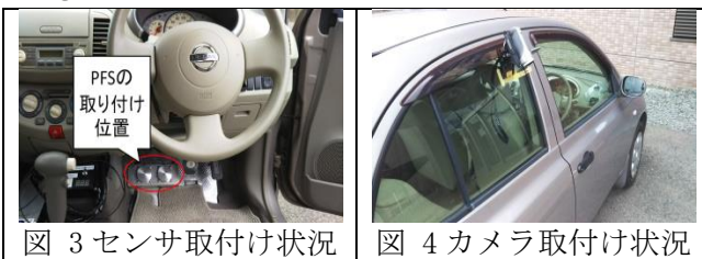
図 3 センサ取付け状況
