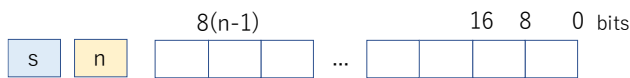
図 1 多倍長整数型の実装例。この例では 1 バイトの符号無し整数型の配列で数値を保存する
