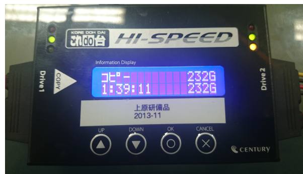
図 2 HDD:250GB の物理コピーの様子
