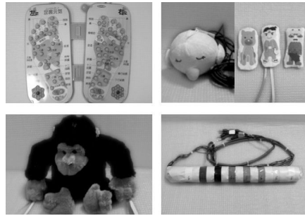
図 3 手作りインタフェースの例 (左上: 足ツボマット型, 右上: ボール型・指人形型, 左下: ヌイグルミ型, 右下: 棒型)
