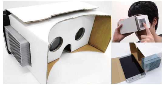
図 11 側面にトラックパッドを持つカードボード HMD Fig. 11 Cardboard HMD with Trackpad.
