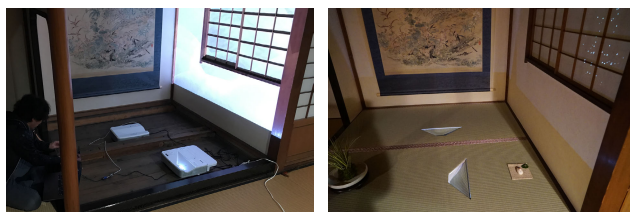
(a) 床の間の畳の下に設置した超短焦点プロジェクタ (b) 穴の開いた特注の畳
