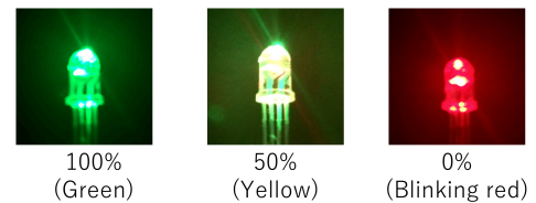
図 3: LEDによる残り時間表示
