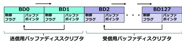
図 3 バッファディスクリプタテーブル
