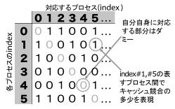
図 2 ピットマップによるプロセス間の親和性情報の表現例 Fig. 2 Example of bitmap which expresses process affinity.
