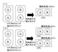
図 13 同一プロセッサ内で同時に実行されるスレッドの組合せ Fig. 13 Pairs of threads running simultaneously on a CPU.
