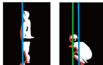
図2 直立する人の背景差分二値画像（左）スクワットをする人の背景差分二値画像（右）
