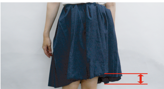
図 5 気温に反応し短く変形するスカート
