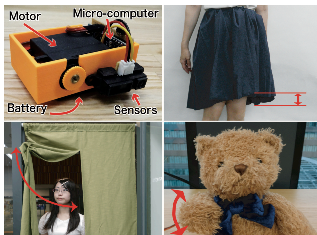
図 1 Filum モジュールのプロトタイプ (左上) と Filum で拡張された 3 つのテキスタイル製品例
