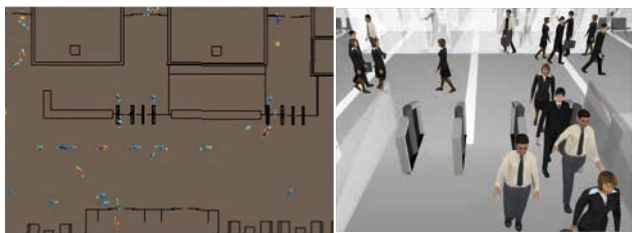
図-5 シミュレーション結果(左) BIMによるシミュレーション結果の可視化(右)
