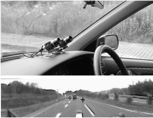
図 17 ドライバ計測カメラと視線の計測結果
