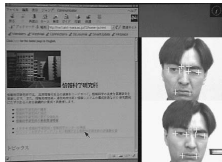
図 10 頭部方向と瞬きを用了ハンズフリーマウス
