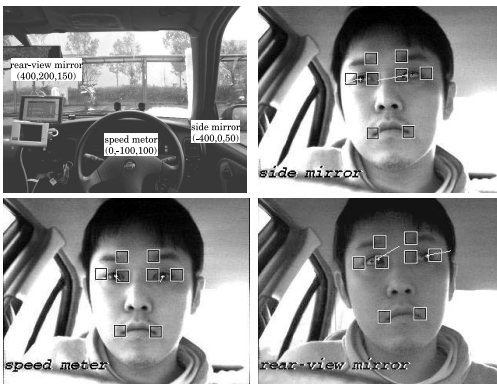
図 18 車内注視の計測結果
