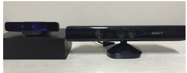
図 3 Realsense と kinect の比較：大きさ
