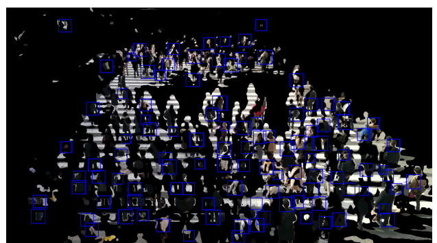
図 2 背景除去と HOG 特徴量による人検出の例
