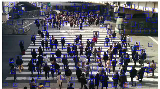
図 1 HOG 特徴量による人検出の例
