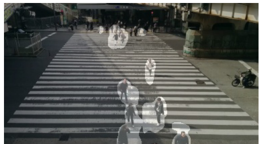
図 16 実環境における動体領域抽出例 Fig. 16 Example of detected moving areas in JR Osaka.
