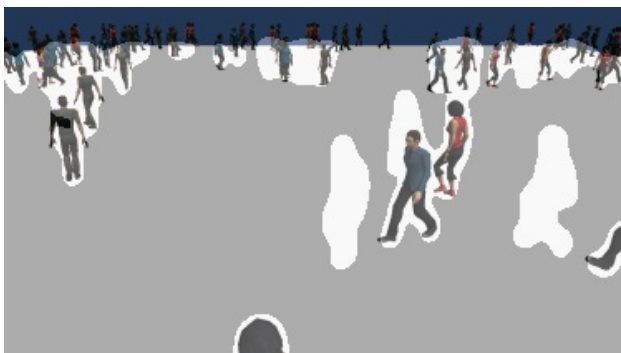
図 14 入力画像と動体領域を重畳した図 Fig. 14 Overlapped image of input and detected moving object areas.
