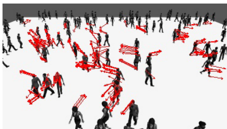
図 9 Unity の実験画像を用いたオプティカルフローの検出例
