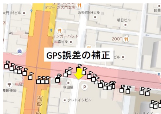
図3. GPS誤差の補正
