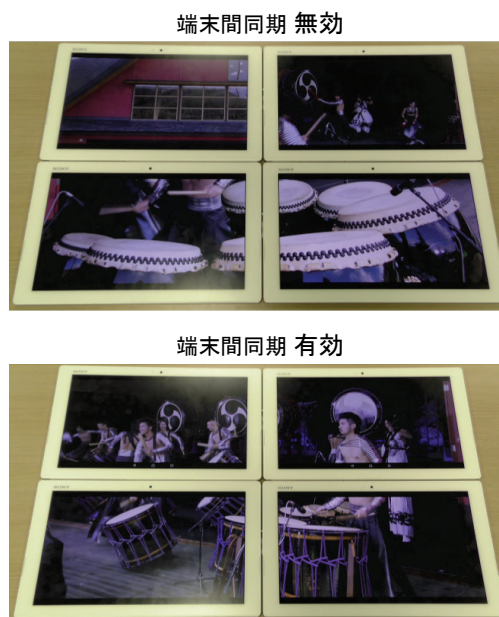
図 10 端末間同期による 8K 再構成 (実験 B)
