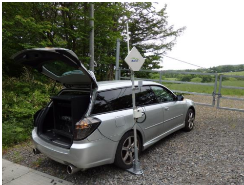
図 17 車載型 NDN システムの設置(移動局側)
