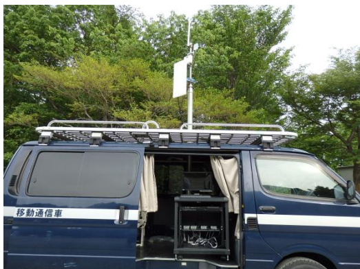
図 16 車載型 NDN システムの設置(駐車場入口側)
