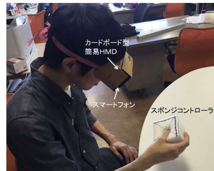
図1 VRシステムとコントローラ Fig.1 Controller in VR system
