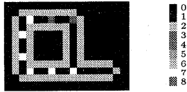
図2 LangtonのSRループの構造。アルファベットのQのような形をした管の中に、腕を1セル分伸長させる信号‘7’が6つ、その後腕を左折させる信号‘4’が2つ（これは2つで1回の左折を実現する）入っている。右のチャートは各セルの状態が図中でどのような色調で示されているかを表している。これ以降の図も同様。
