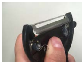
図2 一般に、ピーラーの刃には遊びがある
