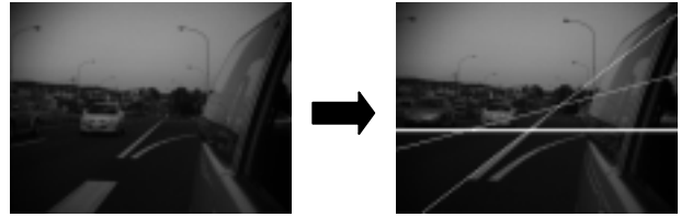
図 3. 白線と車両の検出結果例
