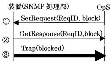
図 2 閉塞要求時の SNMP シーケンス
