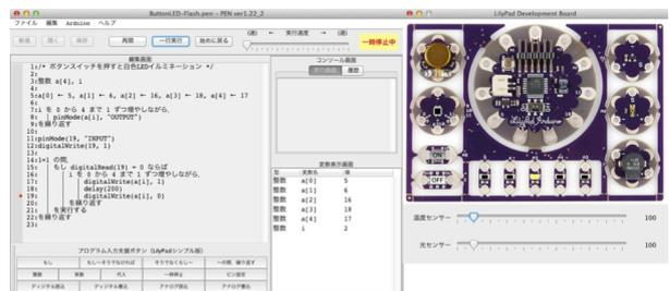
図 2 PEN と LilyPad Arduino シミュレータ実行画面
