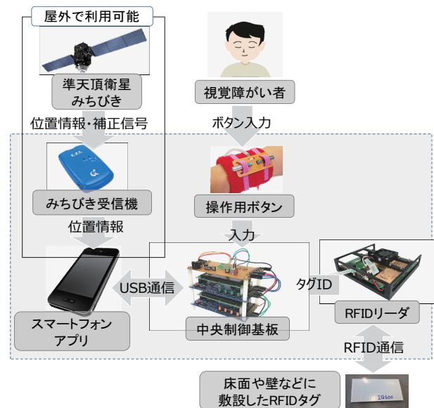
図1 開発したシステムの全体構成図
