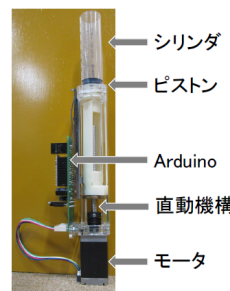
図 5 パーティクル量制御装置
