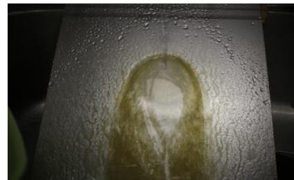
図1 実験で生成した錆
