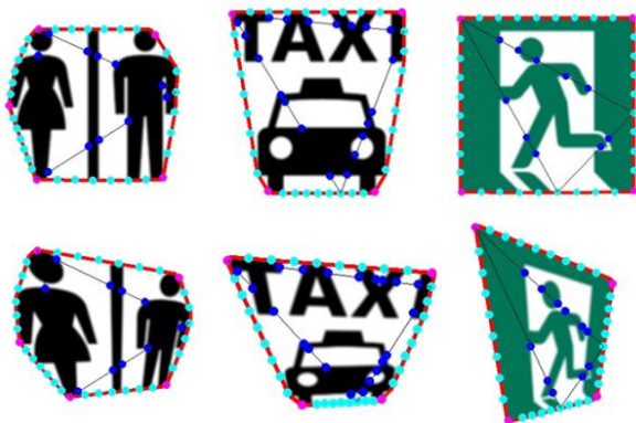
図10 射影変換にロバストなサンプル点の選択 射影変換画像 (上)、参照画像 (下)
