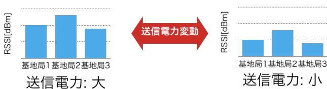
図 9: 送信電力の変動に伴う RSSI の変動
