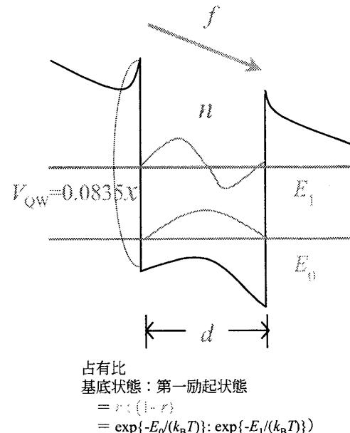
図1：一様な外部電界下にある  $\text{Al}_x\text{Ga}_{1-x}\text{As} / \text{GaAs} / \text{Al}_x\text{Ga}_{1-x}\text{As}$  単一量子井戸中の電子の量子準位
