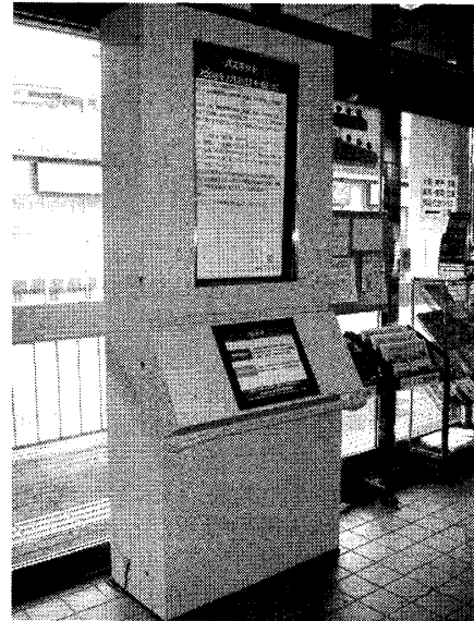
図3: ターミナル型インテリジェントバス停 (鳥取県鳥取市:鳥取駅バスターミナル)
