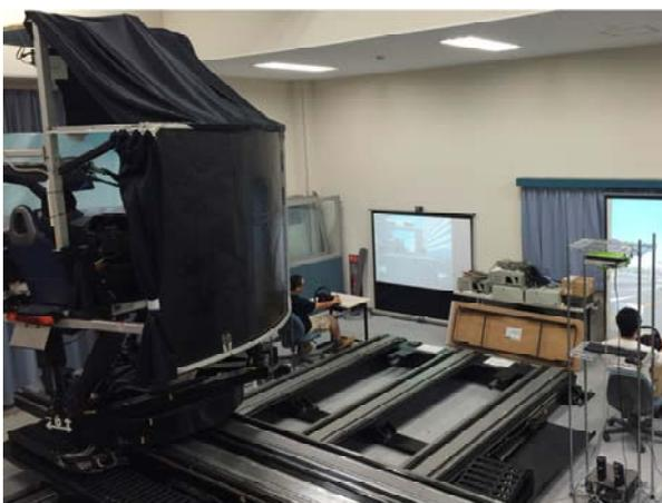
図2 ネットワーク型ドライビングシミュレータ例
